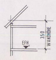
Wandhöhe (WH) die Wandhöhe wird gemessen von Schnittpunkt Aussenkante Mauer, Obekante Decke EFH bis Oberkante Dachdeckung
